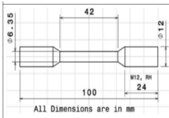
Fig 1: Tensile Specimen.
