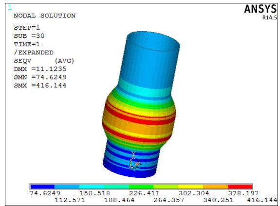
Fig 11: Final von Mises stress
